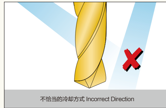
不恰当的冷却方式 Incorrect Direction
